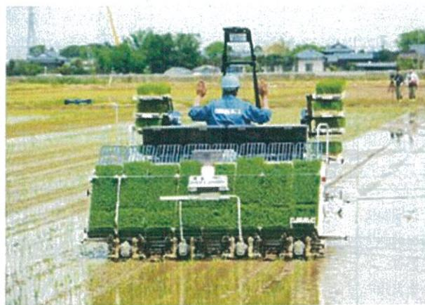
最適施肥により、倒伏軽減と施肥量削減で省力・低コスト化を実現する「可変施肥田植機」に、誰でも簡単にまっすぐ植えることができる「直進アシスト機能」を追加した田植機を「スーパーイコ商品」に認定しました。自動直進機能により、オペレーターの疲労軽減、作業の効率化につながります。また、田植え時に水が多くマーカー跡が見えなくとも田んぼの水量を調整する必要がないため、農業用水の節水や水質保全に貢献します。
